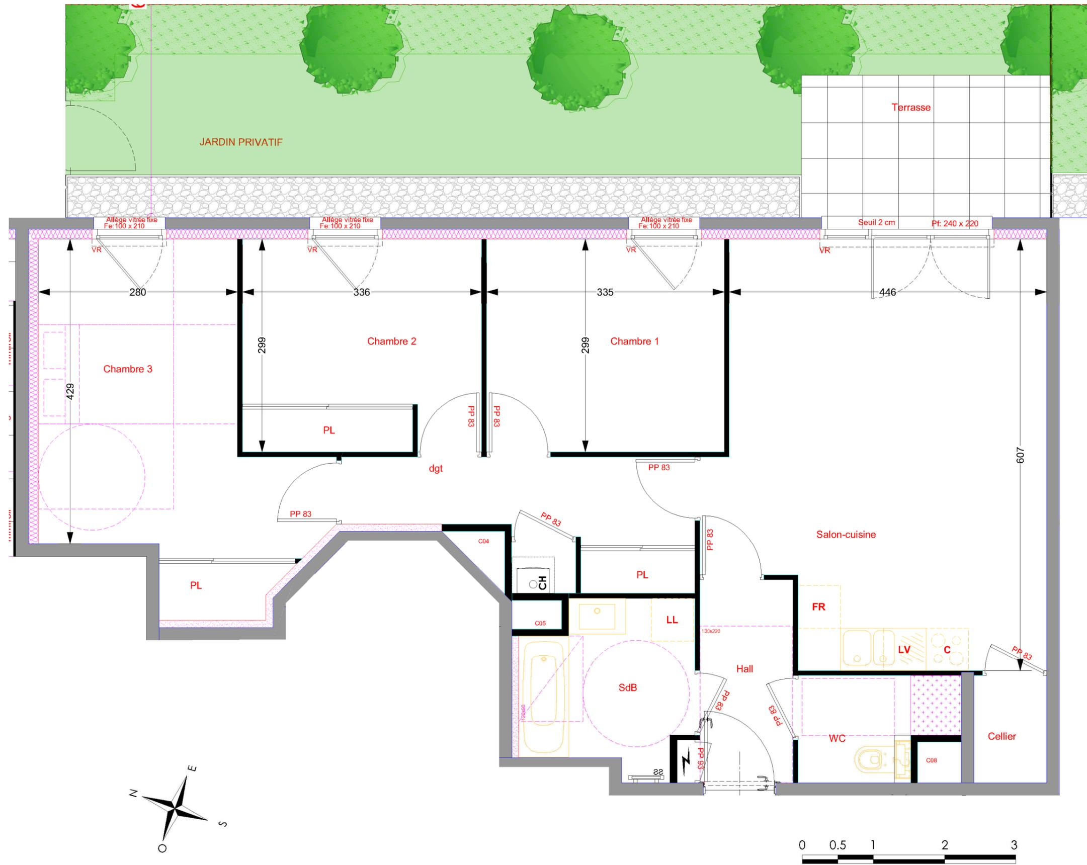
LEGENDE: PF: Porte Fenêtre / F: Fenêtre / FAV: Fenêtre Allège Vitree / VR: Volet Roulant / TE: Tableau Electrique / PL: Placard / CUI: Cuisson / R: Réfrigérateur / LL: Lave Linge / LV: Lave Vaisselle / Soffite, faux plafond :
